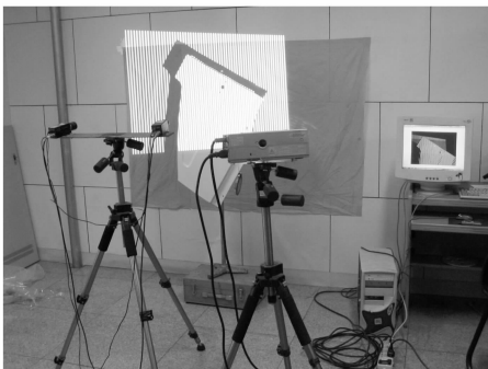
图2 对工件进行测量
